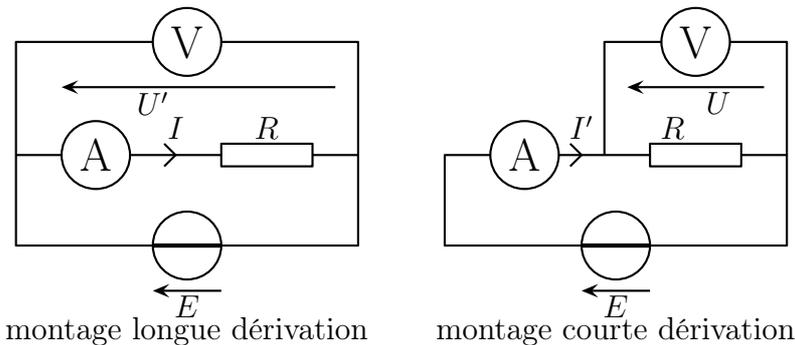
1. Chacun des deux montages permet de mesurer parfaitement une grandeur et fait une mesure erronée de l'autre grandeur. Attribuer à chaque montage la grandeur parfaitement mesurée et expliquer pourquoi il y a une erreur pour l'autre.
