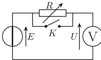
1. L'interrupteur  $K$  est d'abord fermé. Quelle est la tension  $U_0$  affichée par le voltmètre ?
