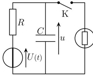
L'interrupteur  $K$  permet de placer en dérivation aux bornes du condensateur un tube à gaz. Ce tube se comporte comme une résistance infinie tant que la tension entre ses bornes est inférieure à une valeur  $V_0$  (inférieure à  $E$ ) et comme une résistance nulle dès que cette tension atteint  $V_0$ . Ceci a pour effet de décharger instantanément le condensateur en produisant un éclair très bref.
