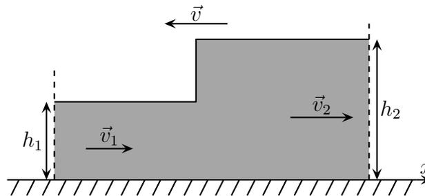
1. On se place dans le référentiel galiléen  $\mathcal{R}_m$  qui se déplace avec le front du mascaret. Effectuer un bilan de masse dans ce référentiel et en déduire une relation entre  $v$  et  $v_2$ . Retrouver cette relation en travaillant dans le référentiel fixe (lié au sol).
