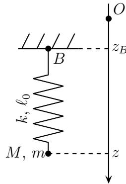
1. Déterminer l'équation d'évolution de la cote  $z(t)$  de  $M$ . On introduira la pulsation propre  $\omega_0$  et le facteur de qualité  $Q$ .
