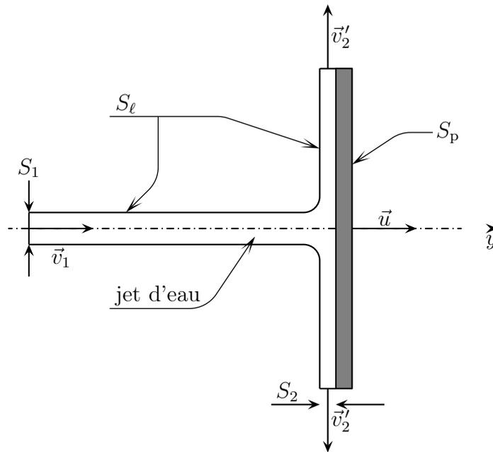
On note  $S_1$  l'aire de la section droite du jet incident,  $S_2$  l'aire de la surface de sortie du jet,  $S_l$  l'aire de la surface libre du jet et  $S_p$  l'aire de la plaque. La pression de l'air ambiant est  $P_0$ . On néglige les effets de la pesanteur.
