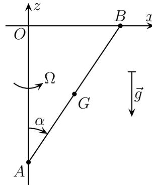
Une tige  $AB$ , homogène, de longueur  $2\ell$  et de masse  $m$ , est mise en rotation par le guide horizontal  $(Ox)$  qui tourne autour de l'axe vertical  $(Oz)$  à la vitesse angulaire constante  $\Omega$ . L'extrémité  $A$  glisse sans frottement sur  $(Oz)$  et l'extrémité  $B$  sur  $(Ox)$  sans frottement. On pose  $\alpha = (\overrightarrow{AO}, \overrightarrow{AB})$  et on note  $J$  son moment d'inertie par rapport à un axe horizontal passant par  $G$ .
