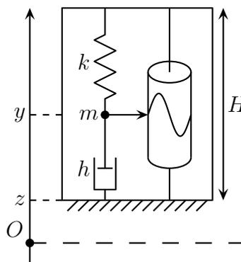
Le cadre est mis en mouvement vertical sinusoïdal :  $z(t) = Z \cos(\omega t)$ . Le référentiel  $\mathcal{R}$  repéré par  $(O, \vec{u}_z)$  est supposé galiléen.
