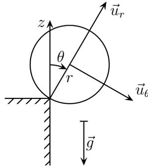
Un cylindre de rayon  $r$ , initialement en équilibre au bord d'une table, tombe sans vitesse initiale. Le coefficient de frottement de l'arête sur le cylindre étant  $f$ . Le moment d'inertie du cylindre autour de son axe géométrique vaut  $\frac{1}{2} m r^2$ .
