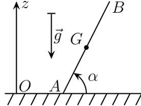
Une tige  $AB$  homogène de masse  $m$ , de longueur  $2\ell$  et de moment d'inertie  $J$  par rapport à un axe horizontal passant par  $G$  est abandonnée sans vitesse initiale dans le champ de pesanteur uniforme  $\vec{g}$  quand  $\alpha = (\vec{OA}, \vec{OB}) = \frac{\pi}{2}$ . Le point  $A$  glisse sans frottement sur le plan horizontal. On notera  $\eta \stackrel{\text{not}}{=} \frac{J}{m\ell^2}$ .
