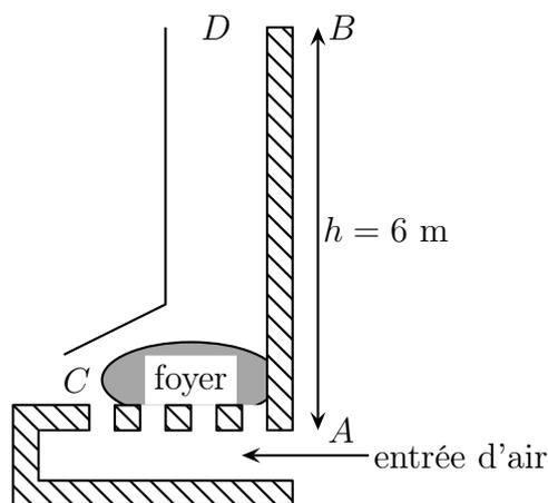
1. Calculer  $p_A - p_B$  où  $A$  est un point dans l'entrée d'air et  $B$  un point en haut de la cheminée.
