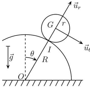
Une boule sphérique de rayon  $r$ , de masse  $m$  et de moment d'inertie  $J$  par rapport à un de ses diamètres est abandonnée dans le champ de pesanteur uniforme  $\vec{g}$  au sommet d'un demi cylindre d'axe horizontal de rayon  $R$ . Le coefficient de frottement est  $f$ .
