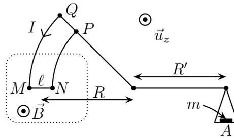
1. Évaluer les actions de LAPLACE s'exerçant sur les brins du circuit mobile, lorsque celui-ci est plongé dans un champ magnétique  $\vec{B}$  qui lui est orthogonal.
