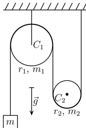
Une masse  $m$  mobile verticalement, une poulie homogène de centre fixe, de rayon  $r_1$ , de masse  $m_1$  et une poulie mobile homogène, de rayon  $r_2$ , de masse  $m_2$  sont assemblés comme sur le schéma ci-dessus. Les brins de fil entre les poulies sont verticaux. Les fils ne peuvent pas glisser sur les poulies
