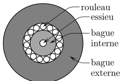
La liaison entre un essieu de centre de masse  $C$ , d'axe horizontal, animé d'un mouvement de translation de vitesse  $\vec{v} = v \vec{u}_x$ , et une roue de rayon  $r$ , est assurée par un roulement à rouleaux constitué :
