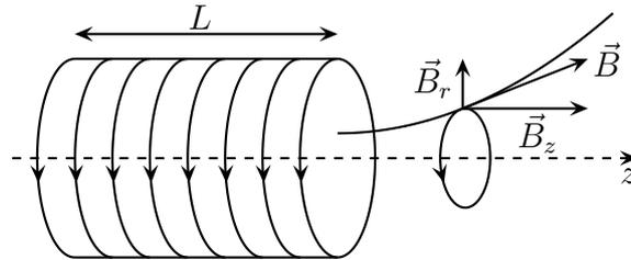
On constate expérimentalement que  $\mathcal{C}$  subit une force  $\vec{F} = F \vec{u}_z$  avec  $F < 0$  qui tend l'attirer vers l'intérieur de  $\mathcal{S}$ . En déplaçant  $\mathcal{C}$  le long de l'axe, on constate que cette force est particulièrement intense quand  $\mathcal{C}$  se trouve au voisinage de la face de sortie de  $\mathcal{S}$ .
