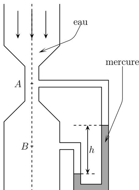
Exprimer  $D_m$  en fonction des diamètres  $\Phi_A$  et  $\Phi_B$  de la conduite en  $A$  et en  $B$ , de la dénivellation  $h$ , de la masse volumique  $\mu_{\text{Hg}}$  du mercure et de la masse volumique  $\mu_{\text{eau}}$  de l'eau.
