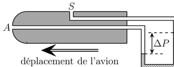
Très loin en amont de l'écoulement, le fluide au repos a une masse volumique  $\mu_0$  et sa pression est  $P_0$ . L'étude est effectuée dans le référentiel où le tube est immobile. Dans ce référentiel, le point  $A$  est un point d'arrêt. L'orifice  $S$  est suffisamment éloigné du point  $A$  pour que l'écoulement n'y soit pas perturbé. Un manomètre différentiel mesure la différence de pression  $\Delta P = P_A - P_S$ . On négligera l'effet de la pesanteur à l'échelle du tube.
