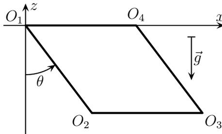
Un losange articulé est constitué de quatre barres homogènes de masse  $m$  et de longueur  $L$  articulées par des liaisons pivots parfaites en  $O_1$ ,  $O_2$ ,  $O_3$  et  $O_4$ . La barre  $O_1O_4$  reste horizontale et fixe, le losange pouvant alors penduler avec un angle  $\theta$  dans son plan vertical. On note  $J$  le moment d'inertie d'une barre autour d'un axe qui lui est orthogonal et qui passe par une de ses extrémités.
