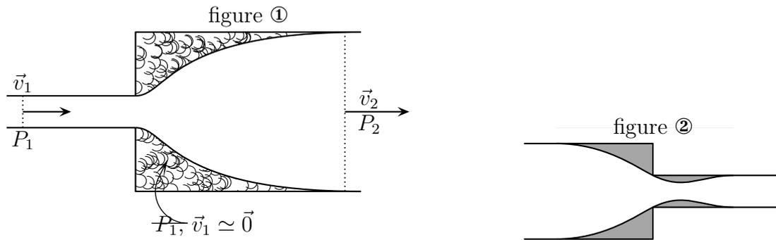
Il se produit alors un décollement des lignes de courant et la création d'une zone d'eau morte dans laquelle l'écoulement est turbulent mais reste à la pression  $P_1$ . Loin de l'élargissement, la vitesse du fluide est  $\vec{v}_2$ , sa pression  $P_2$ . L'air extérieur est à la pression  $P_1$ .
