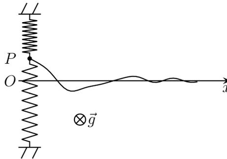
Le point  $P$  se déplace sans frottement sur l'axe vertical  $(Oy)$ . Les deux ressorts sont identiques (raideur  $k$ , longueur naturelle  $\ell_0$ ). Quand le point matériel  $P$ , de masse  $m$ , se trouve en  $O$ , leurs actions se compensent exactement. À l'instant  $t = 0$ , la corde, de masse linéique  $\mu$  et de longueur infinie, est horizontale, elle est tendue avec la tension  $T_0$ . Le point  $P$  se trouvant en  $O$  on lui communique la vitesse  $\vec{v}_0 = v_0 \vec{u}_y$ .
