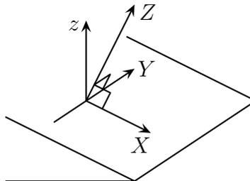
La position d'un point sur le plan incliné est représenté par les coordonnées  $(X, Y)$ .
