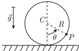
Un point matériel  $P$  de masse  $m$  est solidaire, et à la périphérie, d'un disque homogène de centre  $C$ , de rayon  $R$ , de masse  $M$  et de moment d'inertie  $J$  par rapport à un axe horizontal passant par  $C$ . Le disque roule sans glisser sur un plan horizontal.
