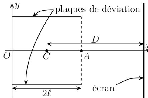
1. Le champ entre les plaques est  $\vec{E} = E_0 \vec{u}_y$ . Déterminer l'équation du mouvement des électrons entre les plaques et leur mouvement ultérieur.
