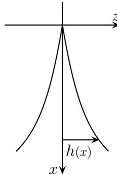
On appelle  $h^*$  une longueur caractéristique suivant  $Oz$  et  $L^*$  une longueur caractéristique suivant  $Ox$ . On suppose que  $h^* \ll L^*$ , que  $h^*$  est de quelques micromètres et que la vitesse de l'écoulement est de l'ordre de un millimètre par seconde. On appelle  $\nu$  la viscosité cinématique du fluide.
