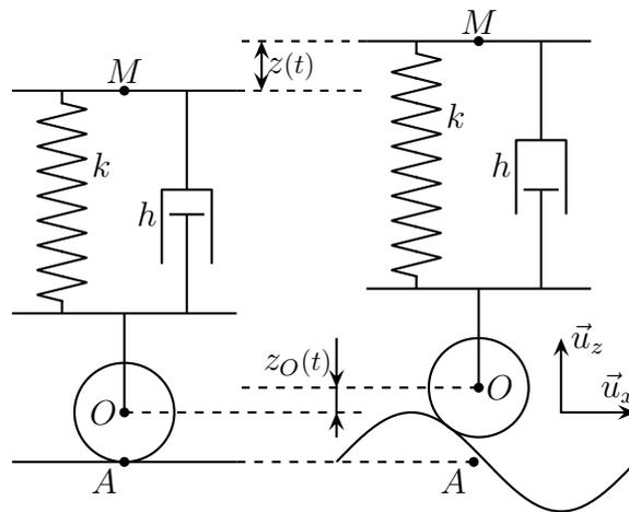
On repère le mouvement de la masse par son déplacement  $z(t)$  par rapport à sa position au repos lorsque le véhicule est immobile.
