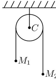
Déterminer  $a_1(t)$  et  $a_2(t)$  ainsi que l'intensité des forces  $T_1$  et  $T_2$  que le fil exerce sur  $M_1$  et  $M_2$ .
