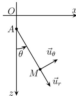
1. Établir l'équation d'évolution de  $\theta(t)$  d'un pendule simple réalisé avec une masse  $m$  placée à l'extrémité d'une tige de masse négligeable et de longueur  $\ell$  dont l'autre extrémité  $A$  oscille verticalement autour de l'origine  $O$  :  $\vec{OA} = h \cos(\gamma t) \vec{u}_z$ . On note  $\omega_0^2 = \frac{g}{\ell}$  et  $\alpha = \frac{h\gamma^2}{g}$ .
