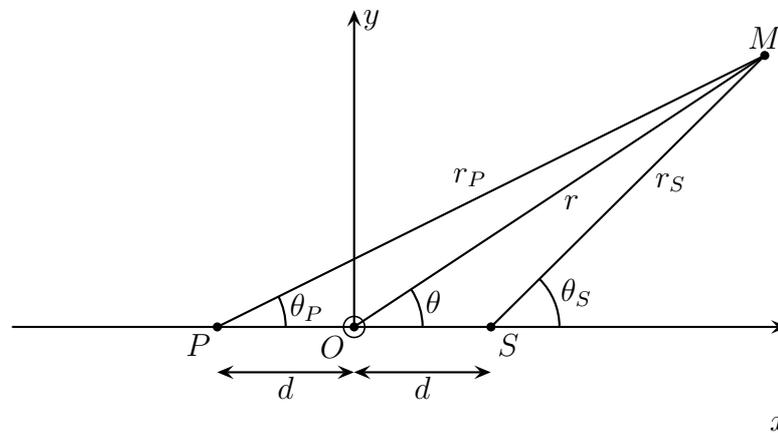
(a) La source se situe le long de l'axe  $Sz$ , le point  $S$  ayant pour coordonnées dans le plan  $xOy$   $(d,0)$  avec  $d > 0$ . L'écoulement s'effectue radialement de façon homogène avec un débit volumique par unité de longueur  $D$ . L'exemple d'un tel écoulement pourrait être donné par un fin tuyau poreux dans lequel on fait circuler de l'eau sous pression.
