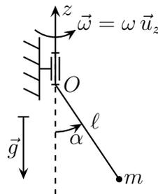
1. En faisant l'analyse des forces dans un référentiel qui sera précisé, calculer  $\cos \alpha = f(\omega)$  et tracer la courbe représentant  $\alpha$  en fonction de  $\omega$ .
