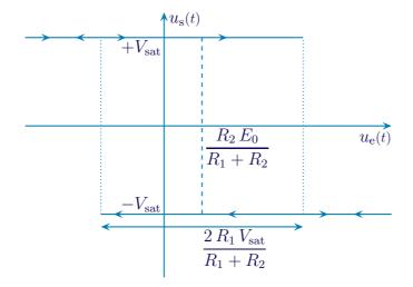
$\Leftrightarrow$  Nous constatons la présence d'un cycle de largeur  $\frac{2R_1}{R_1+R_2}V_{\rm sat}$  et centré sur la valeur  $\frac{R_2}{R_2+R_1}E_0$ .
