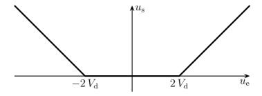
$\Leftrightarrow$  Ici le redressement se fait avec un seuil (qui vaut ici  $2\,V_{\rm d}$ ) puisque c'est la tension minimale à partir de laquelle la tension d'entrée est redressée.
