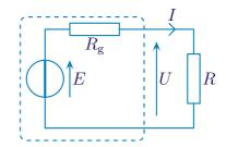
$\diamond$  Nous pouvons constater que les grandeurs U et I sont communes aux deux dipôles. Nous pouvons donc représenter les caractéristiques des deux dipôles dans le même plan (U,I). La partie « source » est donc en convention générateur et la partie « charge » en convention récepteur.
