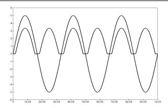
♦ Nous pouvons constater qu'il s'agit là d'un montage redresseur double alternance. Toutefois celui ne semble pas parfait étant donné que lorsqu'elle passe, la tension de sortie de vaut pas exactement celle d'entrée.
