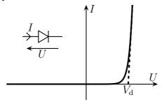
$V_{\rm d}$  est la tension de seuil de la diode.
