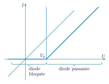
♦ Nous pouvons voir dans la caractéristique précédentes deux zones : une pour laquelle la diode est bloquée, l'autre pour laquelle la diode est passante.
