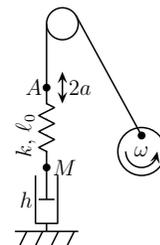
Le dispositif utilisé est un ressort vertical dont l'extrémité supérieure subit des oscillations sinusoïdales grâce à un petit moteur. Dans ces conditions, si on note  $a$  l'amplitude des oscillations du point  $A$ , l'amplitude  $X$  des oscillations de  $M$  vaut  $X = \frac{a}{\sqrt{(1-u^2)^2 + \frac{u^2}{Q^2}}}$  où  $u = \frac{\omega}{\omega_0}$  est la pulsation propre et  $Q$  est le facteur de
