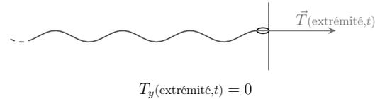
Lorsqu'une corde est accrochée à quelque-chose (ressort, masse, ...) une condition aux limites est donnée par la continuité de la corde et l'autre est donnée par le PFD sur l'objet accroché.
