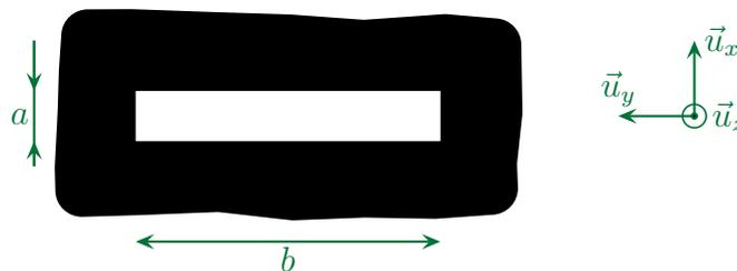
◇ Envoyons une onde plane en incidence quelconque sur cette fente et cherchons l'éclairement observé sur un écran placé dans le plan focal de la lentille.
